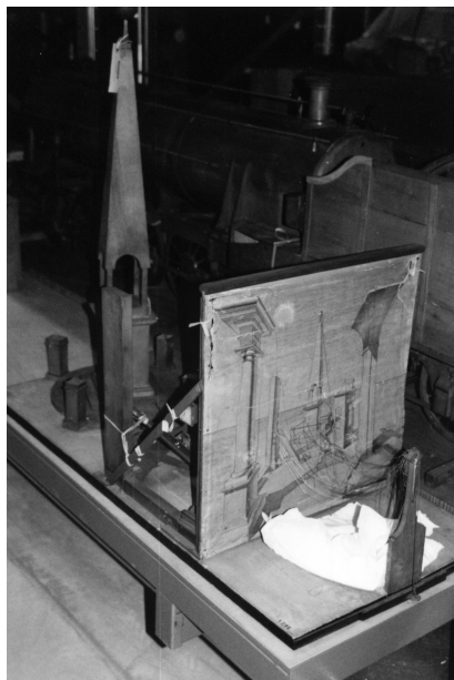
Figur 5: Instrument (defekt) til demonstration af en centralprojektion, Musée des Arts et Métiers, Paris.
